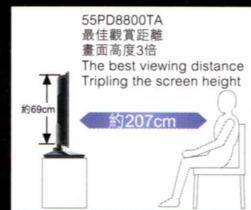
▲ 屏幕高度約69cm x 3 = 最佳視聽距離 The best viewing distance = 3 x screen height (69cm)
